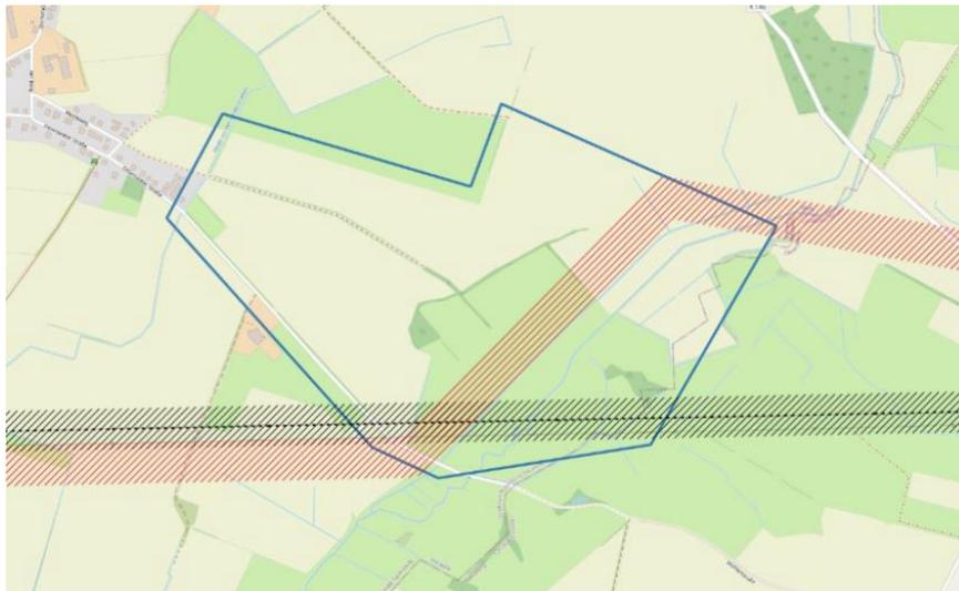
Schraffur rot: Korridor für Neubau A410 380-kV-Leitung
