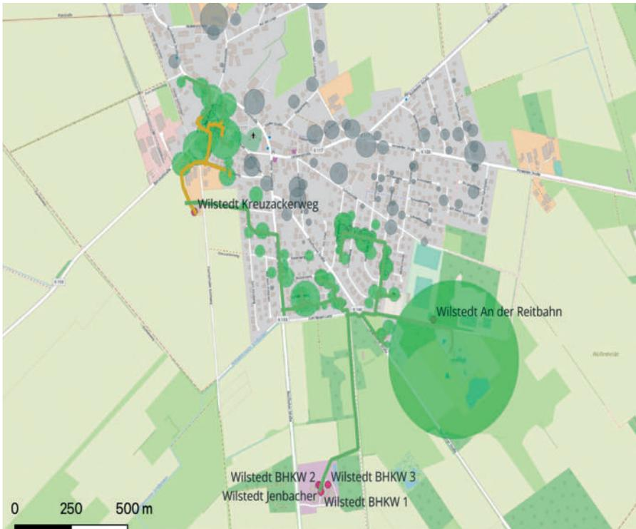
**Wilstedt.** Seit mehr als 20 Jahren gibt es in Wilstedt Biogasanlagen. Dort werden nachwachsende Rohstoffe (Mais, Zuckerrüben, Gras, Ganzpflanzensilage, Gülle) vergärt und daraus Biogas gewonnen. Dieses wird genutzt, um Strom zu erzeugen. Das geschieht in mehreren sogenannten BHKWs (**B**lock**H**eiz**K**raft**W**erk), in denen das Biogas mit Hilfe angepasster Lkw-Dieselmotoren Generatoren antreibt,
