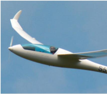
Propeller sehr eng an den Rumpf an und erzeugt fast keinen Widerstand. Im Kraftflug wird er durch die Rotation und die damit verbundene Zentrifugalkraft herausgeschleudert und treibt das Flugzeug an.
