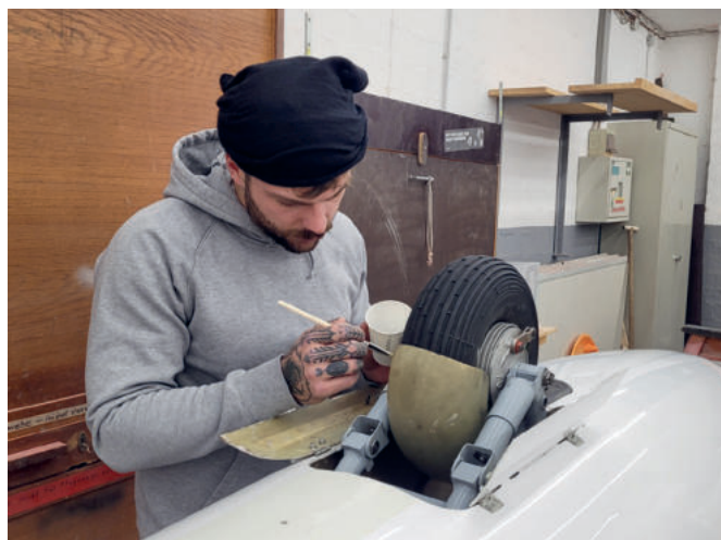
Lackarbeiten am Fahrwerk eines Einsitzers.
