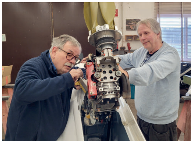
Wartung am Heimkehr-Treibwerk eines Segelflugzeuges.
