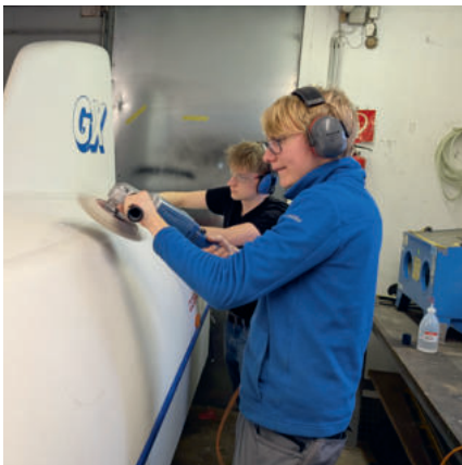
Polieren einer Anhänger-Oberfläche.
