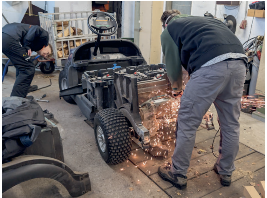
Unser Caddy bekommt eine stabilere Anhängerkupplung.
